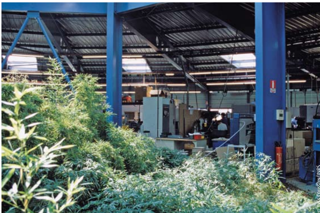
Solution « naturelle » pour la protection solaire : la plantation d'arbres qui permet de réduire les apports de chaleur et de lumière l'été, et d'en bénéficier l'hiver, lorsque le feuillage est tombé.
