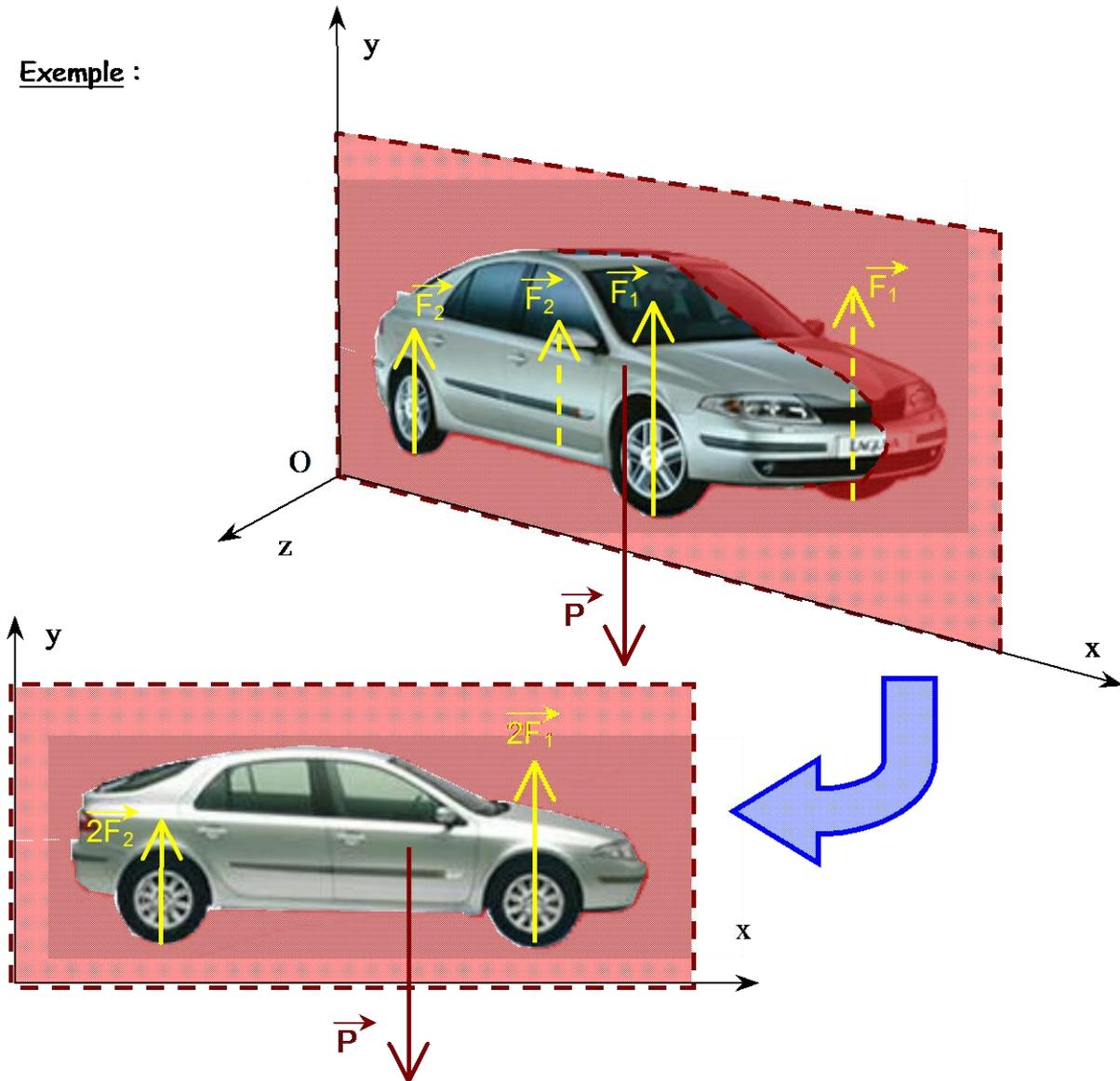
Le plan (O,x,y) est plan de symétrie de la géométrie et des A.M. extérieurs donc toutes les A.M. s'écrivent sous la forme suivante :
