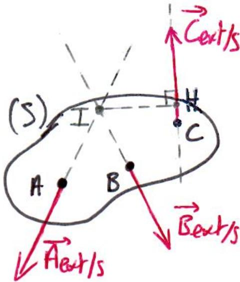
Soit I le point d'intersection des droites d'action de  $\vec{A}_{ext \rightarrow S}$  et  $\vec{B}_{ext \rightarrow S}$
