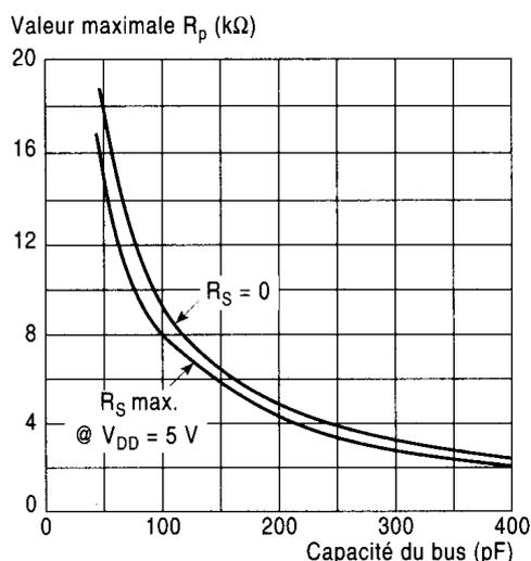
On peut donc conclure que 400 pF représentent une chargeabilité maximale de 19 (+ 1, le maître) circuits à capacité maximale de 20 pF ou que l'on peut déporter un circuit (de 20 pF max) à 3,6 m en le reliant avec du câble à 100pF/m.
