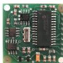
Le calibrage peut être fait de deux manières : par la méthode matériel, à l'aide de l'entrée de calibration ( broche 6 ) ou par la méthode logiciel, à l'aide du bus **I2C**.
