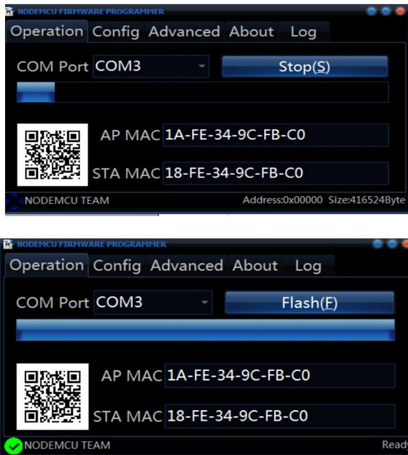
Une fois le module flasher, retirer le strap entre GP00 et GND.
