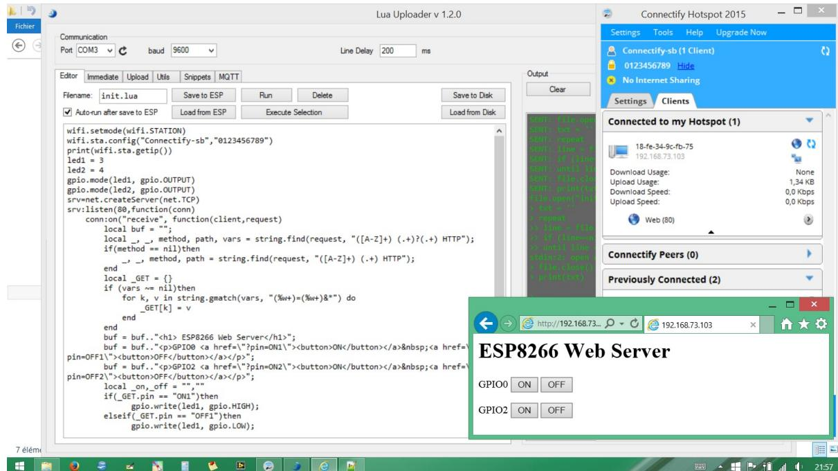
Dans l'exemple une connexion WiFi est créée grâce à Connectify avec comme SSID : Connectify-sb et Password : 0123456789
